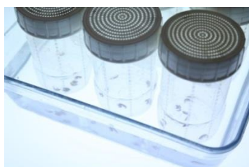
Figure 10 : Cylindres en polypropylène utilisés pour l'encagement de gammares
