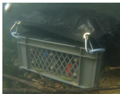
Figure 14 : Système d'immersion contenant les cages de gammars
