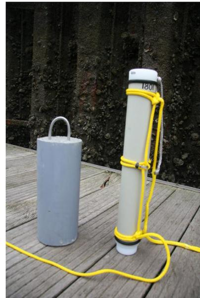
Figure 14 (à gauche) : Système de mouillage utilisé pour l'immersion des C-PODs (© OCEAMM)
