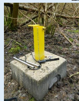
Photographie d'un capot de piézomètre et de son socle in-situ.
