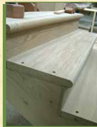
Escalier en frêne
